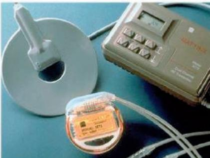
*Beispiel eines implantierbaren Elektroden-Empfängersystems mit Antenne und externem Sender*
